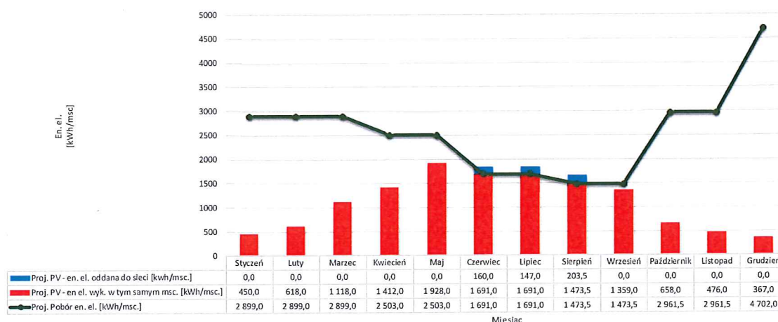
Rys. 25 Wykres obliczeniowej produkcji en. el. z instalacji w odniesieniu do realnego zapotrzebowania na en. el. przez obiekt
